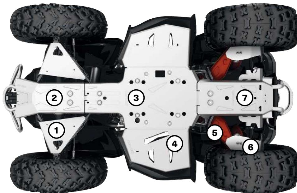
Para máxima durabilidade e resistência, nossas placas de alumínio são feitas de alumínio 5052 H32 de alta resistência com 4,5 mm (3/16") de espessura.
