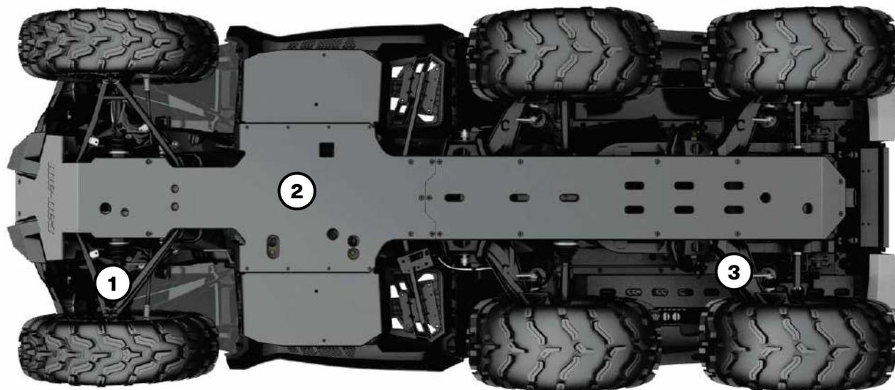
Nossas placas de plástico e alumínio deslizam suave e silenciosamente sobre obstáculos, oferecendo grande proteção em terrenos acidentados.
